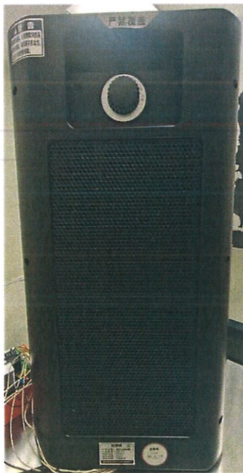
图 1 能隙发热设备进风口（尺寸高 390mm×180mm）
